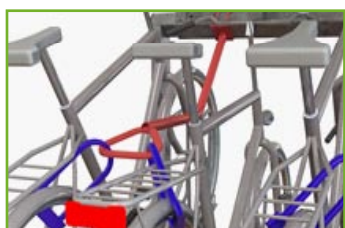
ulteriore possibilità di fissaggio del telaio (piano sotto) zusätzlich Möglichkeit zur Befestigung des Rahmens (Boden unten)
