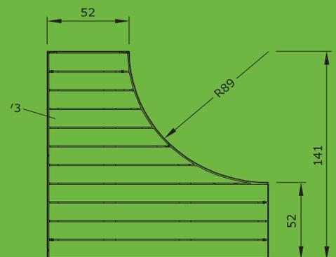
*Unterkonstruktion:* aus Stahlblech 8 mm, Ummantelung aus Blech 2 mm, oben mit Umschlag nach innen, verzinkt und pulverbeschichtet in RAL-Farbe nach Wahl.
